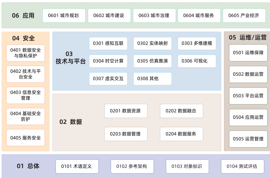
图 6 城市数字孪生标准体系结构图
